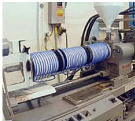
Figura 26. Extrusora con cilindro calentado mediante inducción
